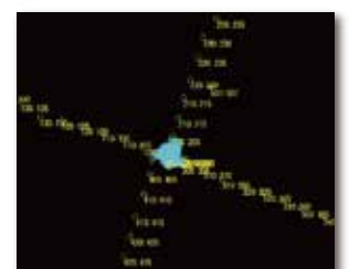
補正データ（青）と生データ（黄） 補正データの較差は5cm以内
