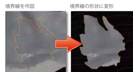
境界線を作図 境界線の形状に変形 「面境界の追加と削除」を利用すると、面の外形を自由に成形することができます。面の内部または外部に穴や島を作成することも可能です。
