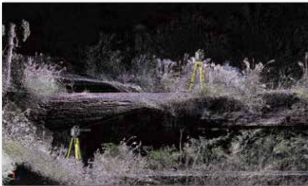
TBCの作業ウィンドウで表示展開する点群とTrimble SX10
